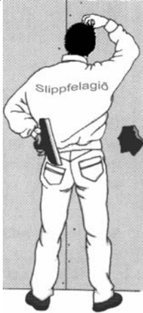
Mynd 42. Í stærri skemmdir sem ekki er hægt að spartla í er hægt að loka með gifsplötubút.
